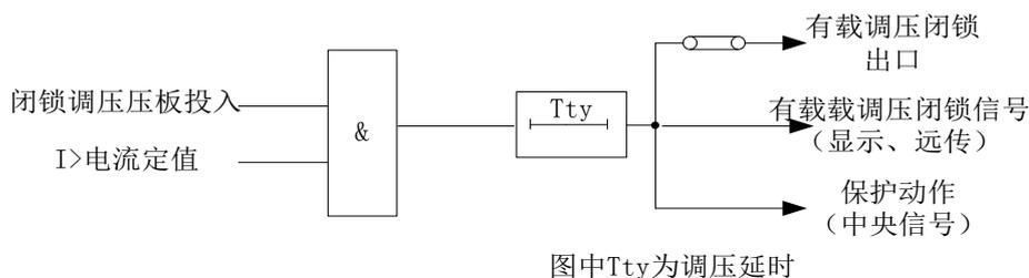
图 4-10 闭锁有载调压保护逻辑框图
