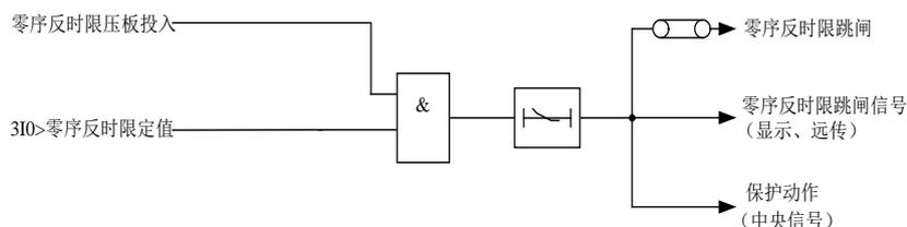
图 4-8 零序反时限逻辑框图
