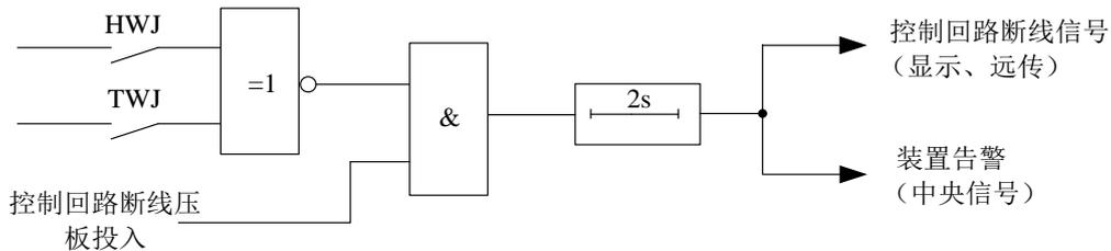
图 4-13 控制回路断线检测逻辑框图
