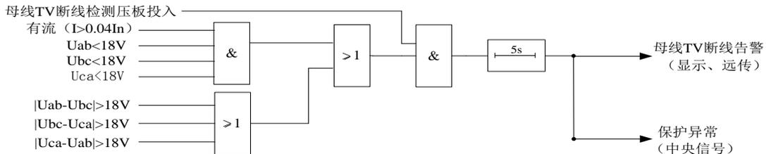
图 4-12 母线 TV 断线检测逻辑框图
