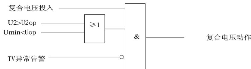
图中  $U_2$  为负序电压， $U_{min}$  为最小线电压
