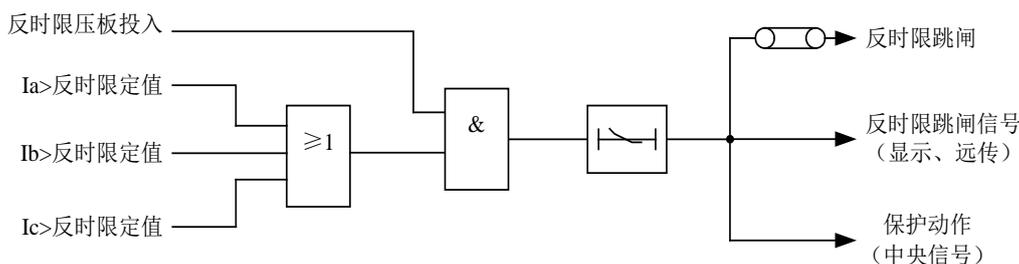
图 4-7 过流反时限逻辑框图
